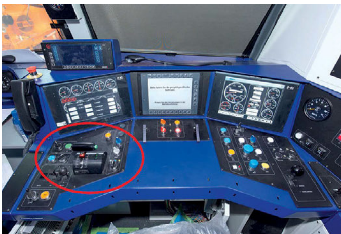
Abb. 4: Fahrstand einer Stopfmaschine mit dem charakteristischen Fahr-Bremshebel von P&T
