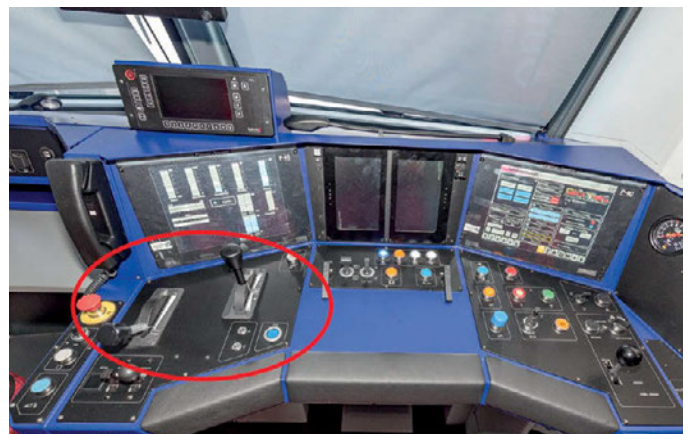
Abb. 5: Fahrstand Oberbaufahrzeug CatenaryCrafter mit Geschwindigkeits-Vorwahlhebel und Fahr-Bremshebel (elektrodynamische Bremse und Schnellbremsstellung)
