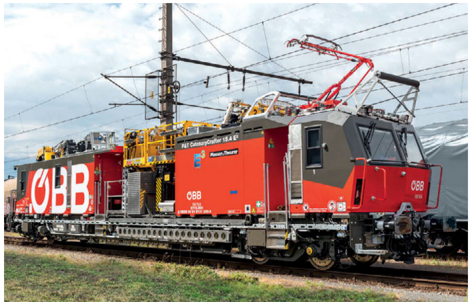
Abb. 2: Hochleistungs-Instandhaltungsfahrzeug Plasser CatenaryCrafter für die ÖBB-Infrastruktur AG
